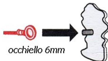
La nuova presa di diagnosi può essere fissata sul rivestimento inferiore della plancia lato passeggero.
